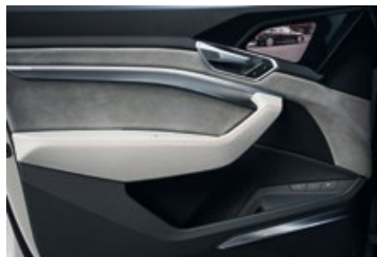
El Audi e-tron es el primer vehículo de serie en el mundo en utilizar un sistema de espejos retrovisores virtuales. El conductor ve las imágenes que toman las cámaras exteriores en unas pantallas situadas en la parte superior de las puertas.
