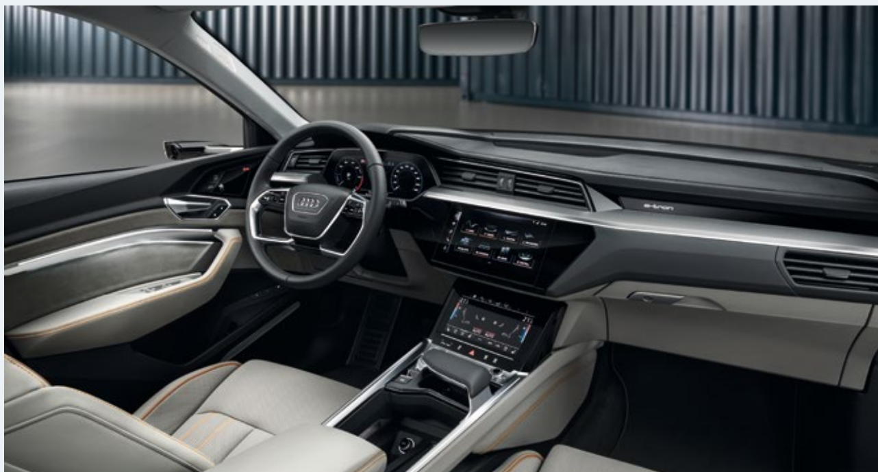
El sistema de alta gama MMI Navegación plus es de serie en el Audi e-tron. Incluye la instrumentación digital Audi virtual cockpit, y dos pantallas táctiles con diagonales de 21,8 y 25,6 cm respectivamente, que cuentan con feedback háptico.
